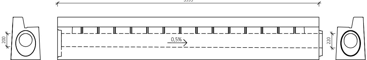
BEST TROUBA S PRŮBĚŽNÝM ŠTĚRBINOVÝM ŽLABEM, OBRUBNÍK 15 cm (PROFIL PRAVÝ)
