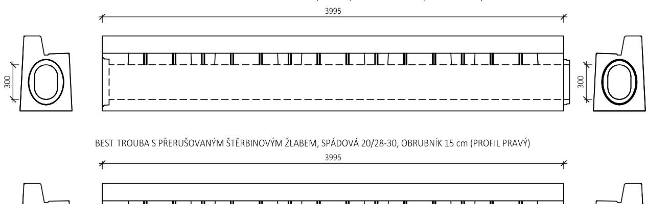
BEST TROUBA S PŘERUŠOVANÝM ŠTĚRBINOVÝM ŽLABEM, SPÁDOVÁ 20/28-30, OBRUBNÍK 15 cm (PROFIL PRAVÝ)
