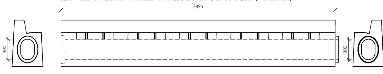
BEST TROUBA S PŘERUŠOVANÝM ŠTĚRBINOVÝM ŽLABEM, SPÁDOVÁ 20/28-30, OBRUBNÍK 18 cm (PROFIL PRAVÝ)
