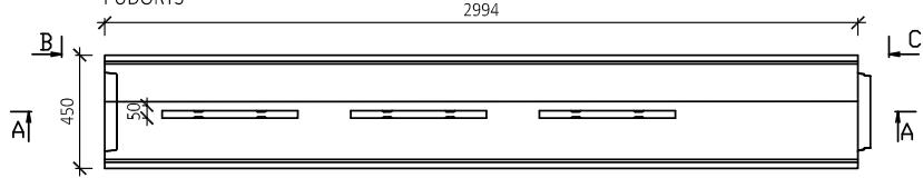
BEST TROUBA S PŘERUŠOVANÝM ŠTĚRBINOVÝM ŽLABEM 2 m, OBRUBNÍK 7 cm (PROFIL PRAVÝ)
