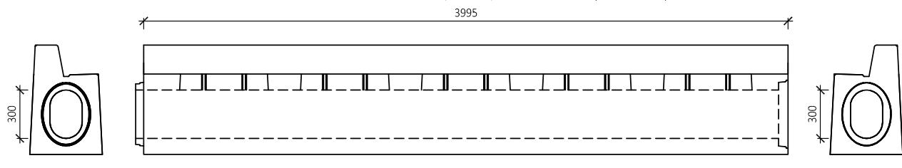
BEST TROUBA S PŘERUŠOVANÝM ŠTĚRBINOVÝM ŽLABEM, SPÁDOVÁ 20/28-30, OBRUBNÍK 18 cm (PROFIL LEVÝ)
